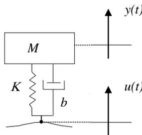
Nella figura la sospensione è rappresentata da una molla con coefficiente elastico  $K$  [N/m] e da uno smorzatore con coefficiente di smorzamento  $b$  [N s/m]. Si considera come ingresso  $u(t)$  la posizione della ruota sul fondo stradale e come uscita  $y(t)$  la posizione della massa sospesa. La forza peso si trascura supponendo che essa venga bilanciata dalla tensione della molla nella condizione di equilibrio (modello alle variazioni).
